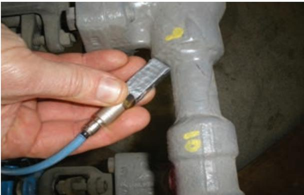
▲ 接口焊缝的检测
