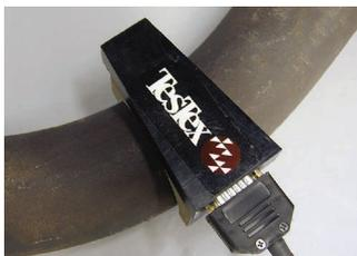
检测弯管内侧的扫描仪
