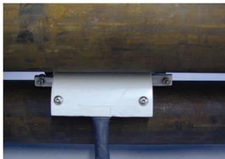
采用低矮型设计，适用于管道间狭窄区域和难以到达的区域，可在最低 12 毫米的空间内可用
